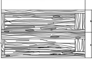
**10.** Construcció de l'armari de Neteja del Bar amb fusta d'iroko acabada amb berrís a l'aigua. Una fulla portarà passador a dalt i al terra, i l'altre tirador amb molla. El tirador serà com el que es detalla a aquest plànol 8.
