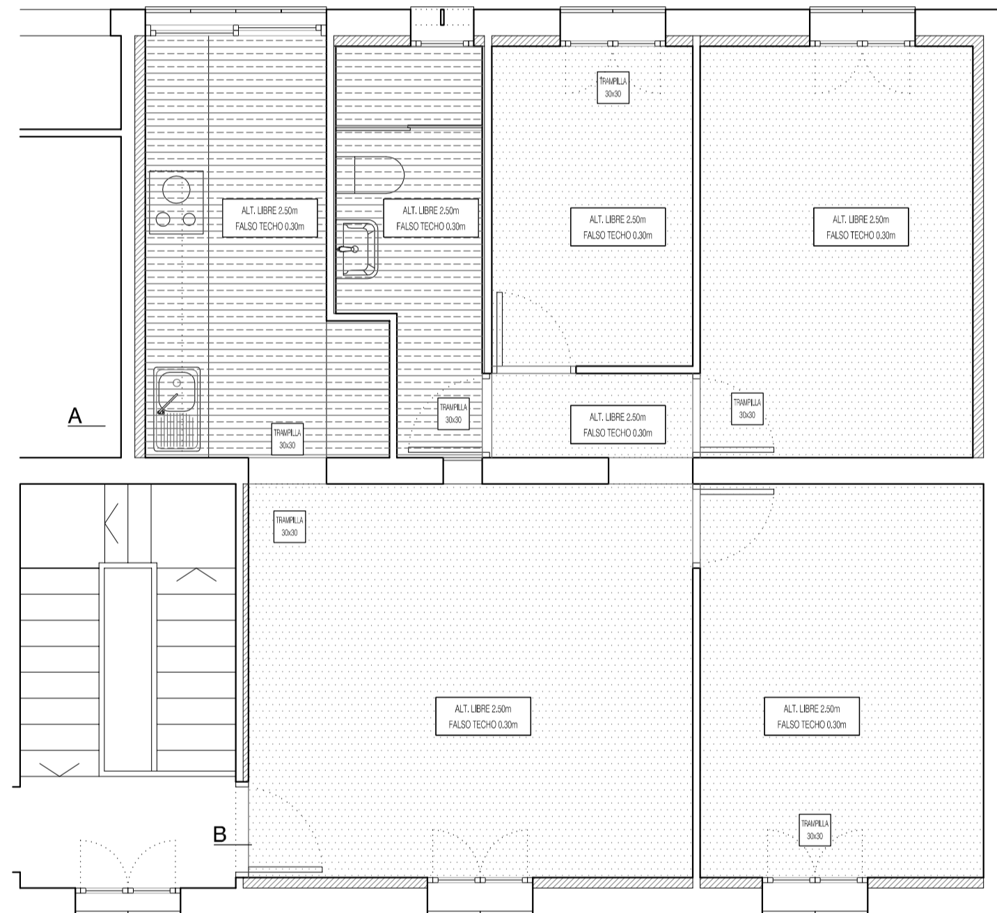
FALSOS TECHOS 1/50 Ubicación y recorrido provisional de instalaciones. Los pasos definitivos se establecerán en obra por la DF previa revisión.
