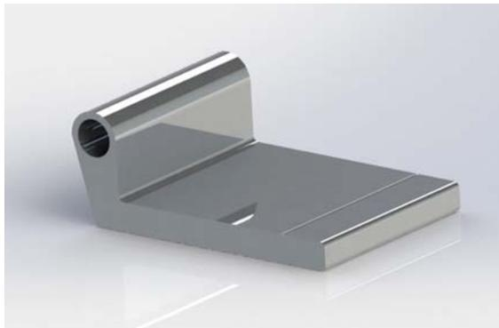
4. **Grapas de fijación:** Para la fijación de los módulos se utilizan dos tipos de grapas. La grapa-G6 para fijación de dos módulos contiguos (intermedia) y la Grapa-G7 para la fijación de un solo módulo (finales). Dicha grapa viene referenciada con un número que indica el grosor del panel a fijar, ejemplo, Grapa-G7/50 es la grapa para la fijación de módulos de 50 mm de grosor.
