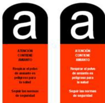
**Figura 1.** Etiquetas normalizadas para señalar los elementos que contienen amianto
